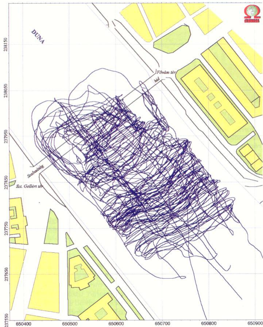
2. ábra. A Duna Szabadság híd alatti szakaszán végzett egycsatornás ultranagy felbontású szeizmikus szelvényezés helyszínrajza. A területet kereszt- és folyásirányú szelvények együttes hálózatával mérték fel
