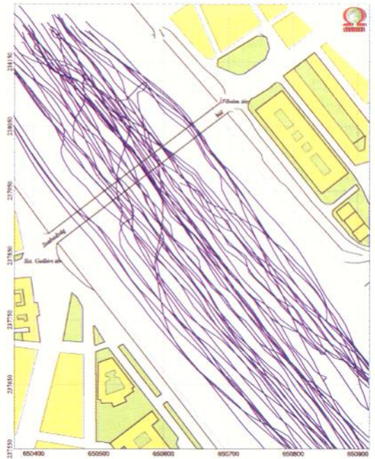
5. ábra. A többcsatornás mérés egyes szelvényeihez tartozó forrásponatok nyomvonala. A mérés során összesen 46, közel folyásirányú vonalpárral mérték fel
