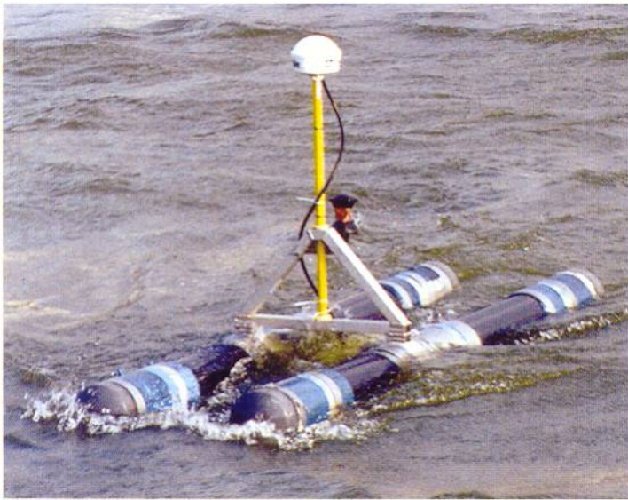
4. ábra. Az egycsatornás mérés eszköze, valamint az alkalmazott pozicionálás. Differenciálisan korrigált GPS és automatikus követésű lézeres teodolit együttes alkalmazásával lehetett megoldani a kellő pontosságú, navigációt is lehetővé tevő helymeghatározást az egész felméréndő területen. A képen a GPS antenna és a lézeres teodolit 360°-os prizmjája látható egymás felett, a mérőműszer geometriai középpontjában
