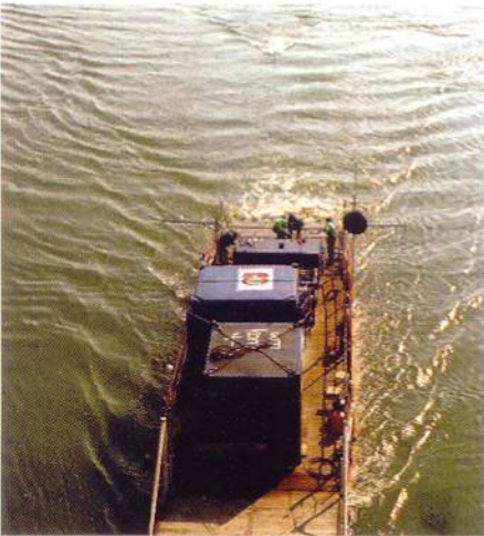
6. ábra. A többcsatornás mérés műszereinek vízbe helyezése. A két hidrofunkábel végét jelölő bólya zászlója fölé erősítve látható a két GPS egység. A hidrofunkábelek még a dobon találhatók, mellettük a piros, szárnyakkal ellátott mélység szabályzó. Középen, a komp végén látható a forrást tartó bólya, rajta a teodolit prizmjával. A 22. oldali képen a komp és a mögötte elhelyezkedő vontatmány látható felülnézetben. A nagy nyomású levegőt előállító kompresszor, valamint a mérési adatokat rögzítő számítógépek a kompon látható konténerekben kaptak helyet. (Tóth Gyula, MTI fotó)
